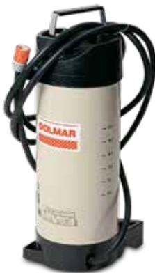
Aus langlebigem Metall. Für die Druckwasserversorgung der Trennscheibe unabhängig von einer Netzwasserleitung und einem Schlauchanschluss. Der Druck wird mit einer Handpumpe auf 3–5 bar gebracht und drückt das Wasser damit durch die Druck- und Fallwasserarmatur bis zur Trennscheibe. Geeignet für handgeführte Einsätze in unterschiedlichen Arbeitshöhen.
