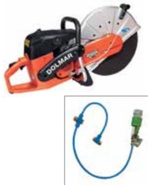
Schlauchsystem mit Steckanschluss, Absperrhahn und 2 Wasserdüsen für den Nassschnitt zur Staubbindung.
