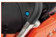
Geringerer Kraftaufwand beim Starten durch **Dekompressionsventil**.
