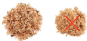
Eine gute Schnittleistung der Motorsäge wird nur mit einer scharfen Sägekette erzielt. Denn scharfe Sägezähne produzieren große Späne. Werden die Späne beim Arbeiten immer kleiner bzw. so fein wie Sägemehl, ist dies ein sicheres Zeichen für eine stumpfe Sägekette. Stärkeres Drücken beim Sägen hilft nicht, sondern erhöht nur den Verschleiß von Kupplung, Schiene und Kette.
